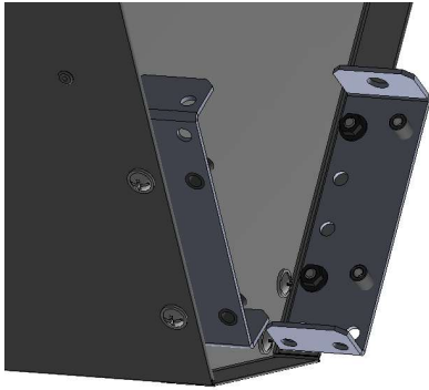
Монтаж крепежа GUARD PRO внутри завесы
